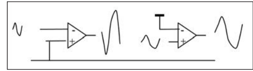
Resp. een inverterende ingang en een niet input inverterende ingang.
